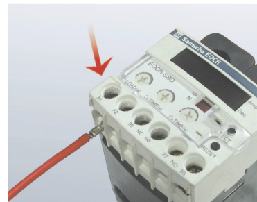
▶나사를 조여 링 터미널 고정한 후
